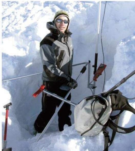
*Profili di neve per misure di movimento invernali del permafrost con il GPS di precisione.
