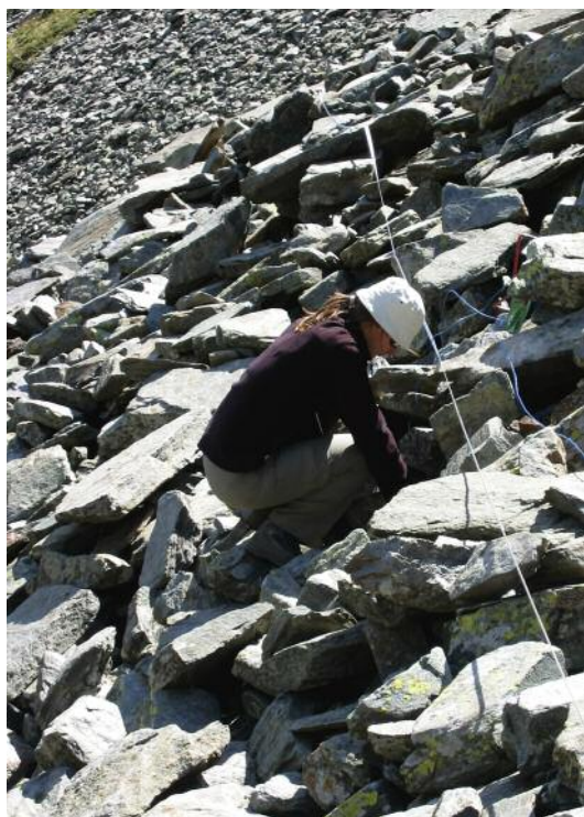
Posa di elettrodi per la realizzazione di un sondaggio elettrico per la prospezione del permafrost in una falda di detrito. Foto C. Scapozza
